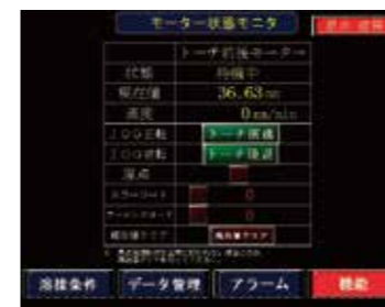
▲トーチ走行モーター状況画面
